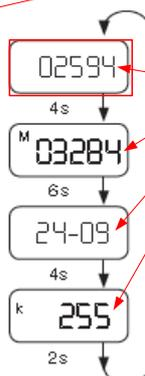
Der elektronische Heizkostenverteiler der Firma Qundis wird über ein LCD-Display abgelesen.
