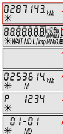
Die Anzeige wechselt durch kurzes drücken der Taste.
